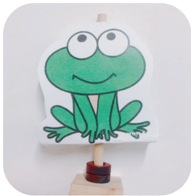
图7 改造后的磁悬浮列车原理演示器材
